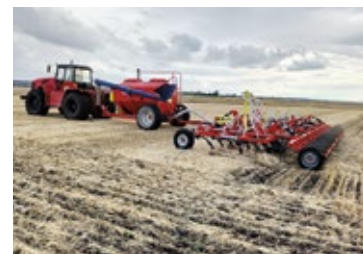
Анкерный посевной комплекс Agrator Ancer 9800 в агрегате с трактором Т-360 на посеве яровой пшеницы
