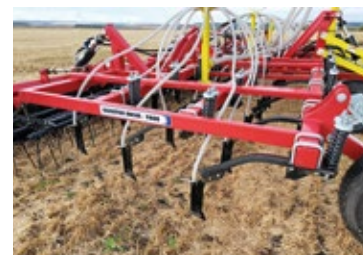
Рабочие органы (долотообразные анкерные сошники, 3-рядные пружинные боронки, прикатывающие пневмоколеса)
